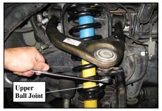
11.Remove the **OE** upper A-Arm pivot bolt.
